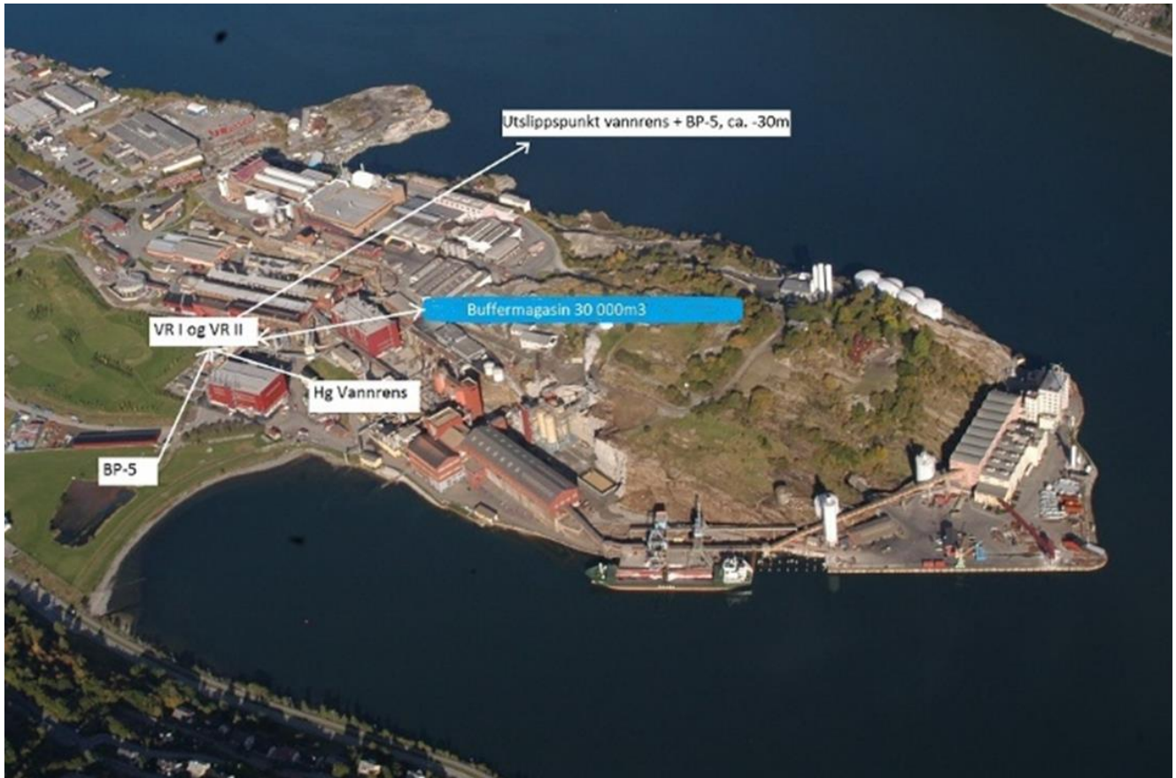
Fig 4.3 Fremtidig planlagt utslippspunkt til Sørfjorden
