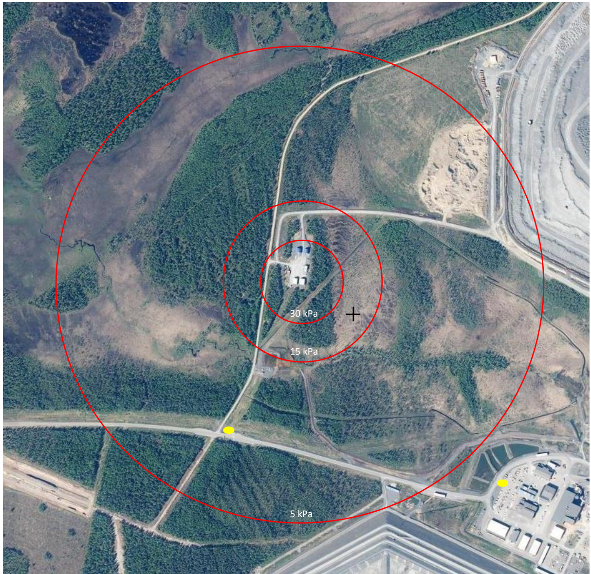
Kuva 1. Keltaisella merkitty kaivosalueen pääportti ja konttorirakennuksen parkkipaikka sekä punaisilla ympyröillä laskennallisen painerintaman sijainti
